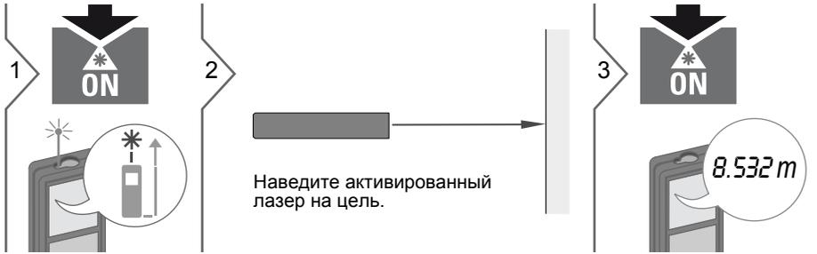
**i** Целевые поверхности: Ошибки при измерениях могут возникнуть в случае выполнения измерений до таких поверхностей, как бесцветные жидкости, стекло, пенопластом, матовые полупрозрачные поверхности или при наведении на очень блестящие поверхности. При наведении на темные поверхности время измерения увеличивается.
