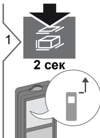
Расстояние измеряется от передней поверхности прибора.
